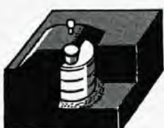
NEDGRAVET BETON-TANK AF GÆNGSE BETONRINGE.
