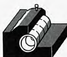
NEDGRAVET RUM AF GÆNGSE BETONRØR ELLER SPECIALFREMST. BETONELEMENTER.
